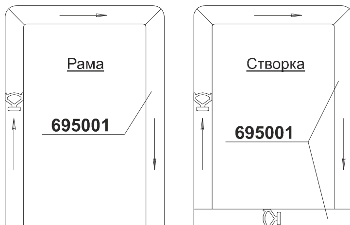
Схема установки уплотнителя под стекло и стеклопакет
